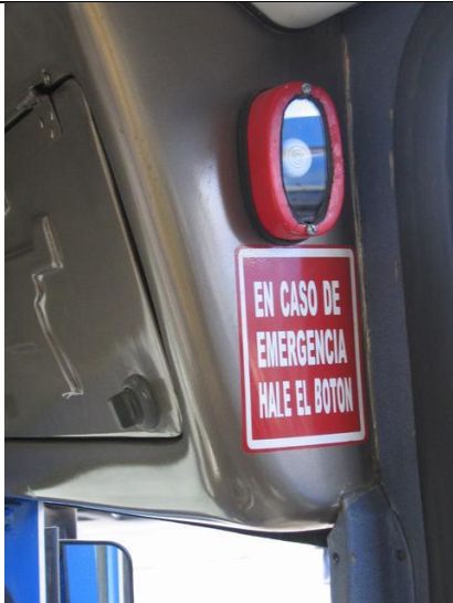
Puerta acondicionada como salida de emergencia
