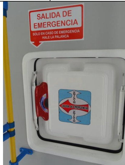
Ventolera acondicionada como salida de emergencia
