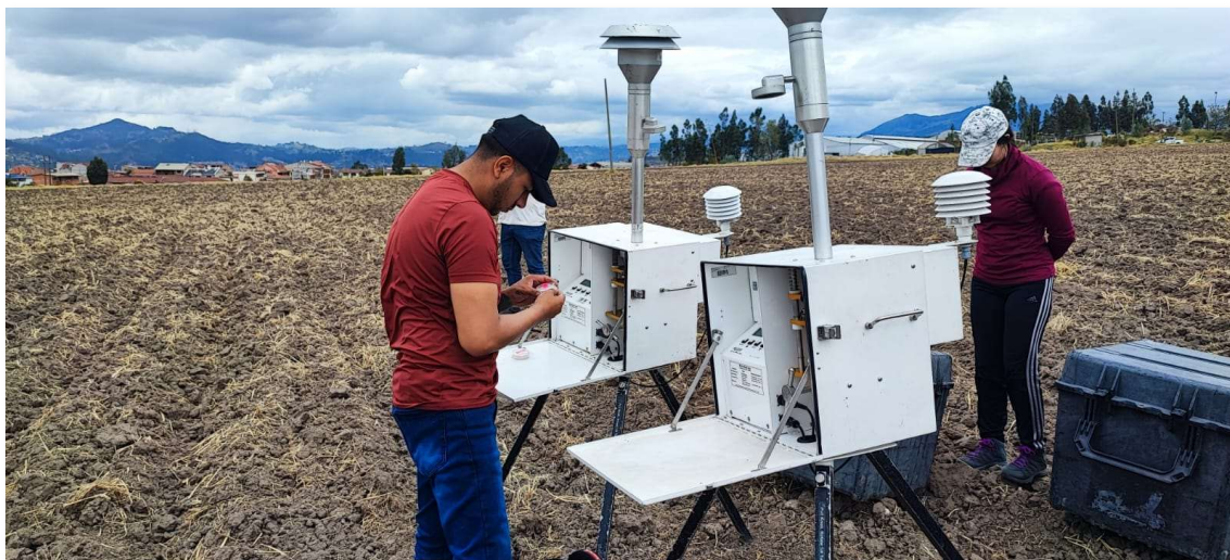
Foto 3 Monitoreo de Material Particulado en el área de Implantación del Proyecto Elaboración: Equipo Consultor 2023
