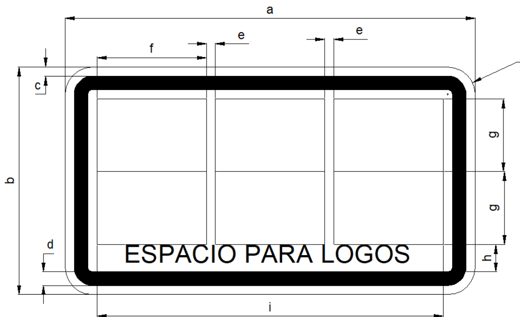
Ilustración 3: dimensiones de la placa para colocación de sellos. Fuente: Elaboración propia, basado en la normativa INEN 004- sección 3.
