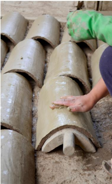
Ilustraciones 65 y 66: Fabricación actual de tejas en Racar.
