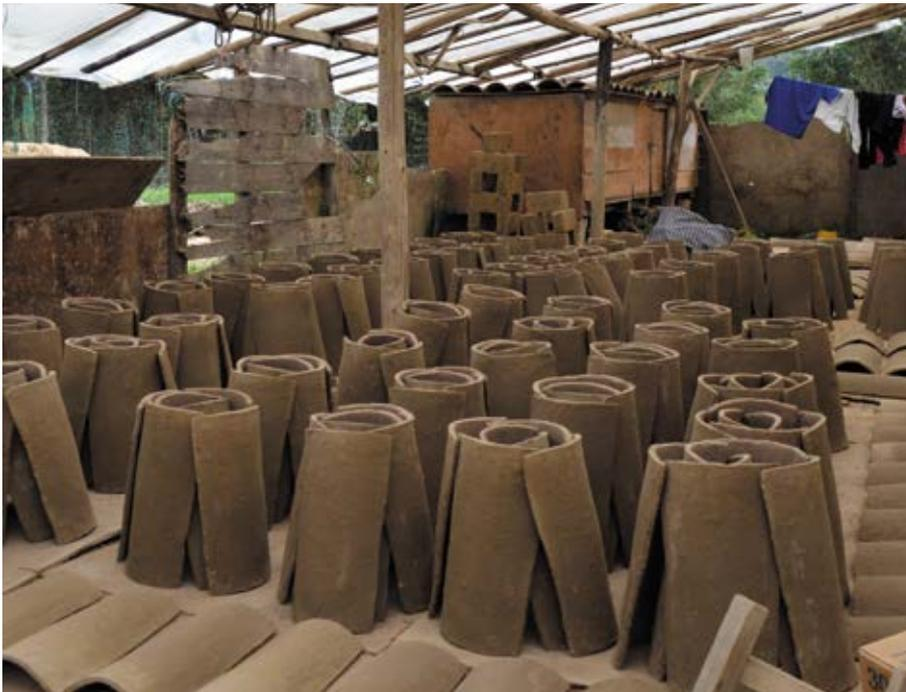
Ilustración 151: Galpón para secado de tejas previa cocción.
