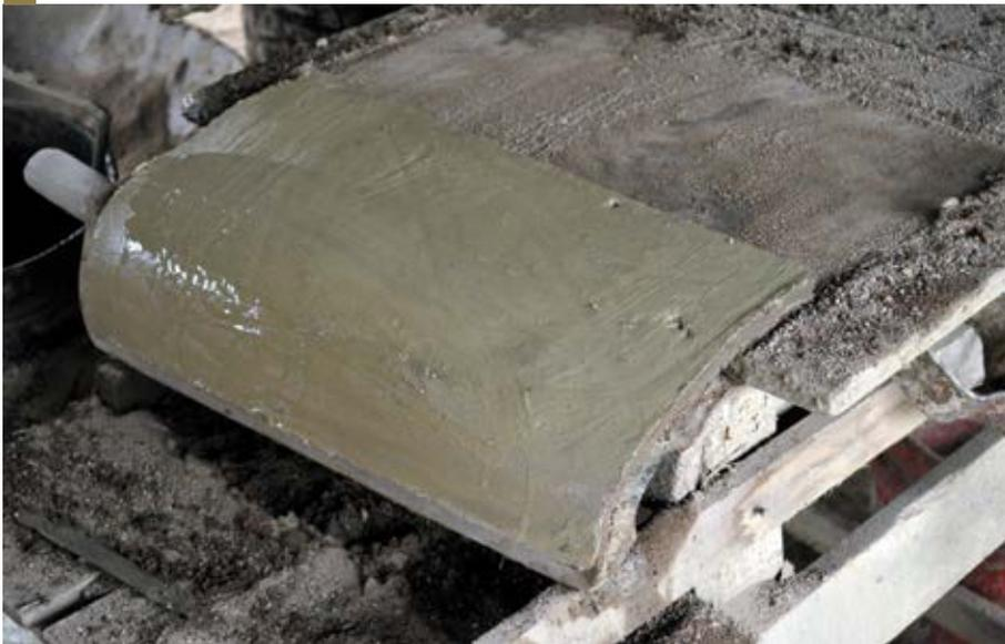
Ilustración 149: Elaboración manual de una teja, desplazamiento del molde.
