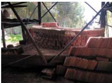
Ilustración 153: Tejas cocidas con el característico color rojo. En la actualidad muchos prefieren la teja barnizada.
