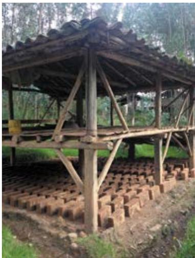
Ilustración 152: Secado de ladrillos en una unidad de producción artesanal.
