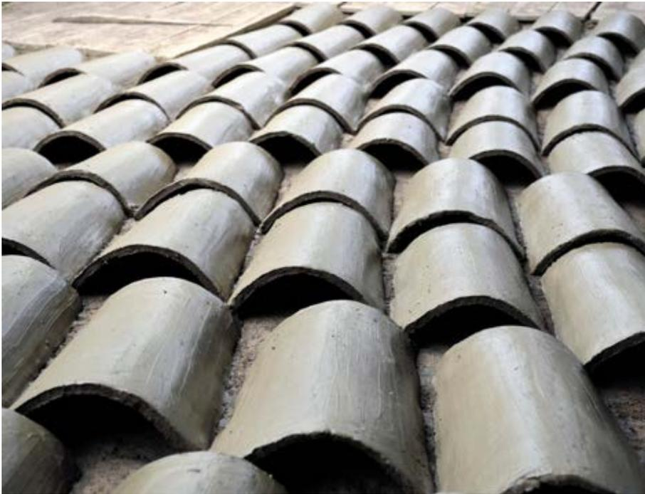
Ilustración 150: Secado de tejas artesanales.
