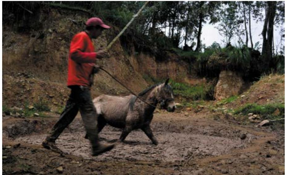
Ilustración 147: Batido de tierra para producción de tejas y ladrillos, proceso que se ha mantenido desde la época colonial.
