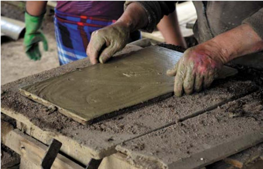
Ilustración 148: Elaboración manual de una teja con un molde.
