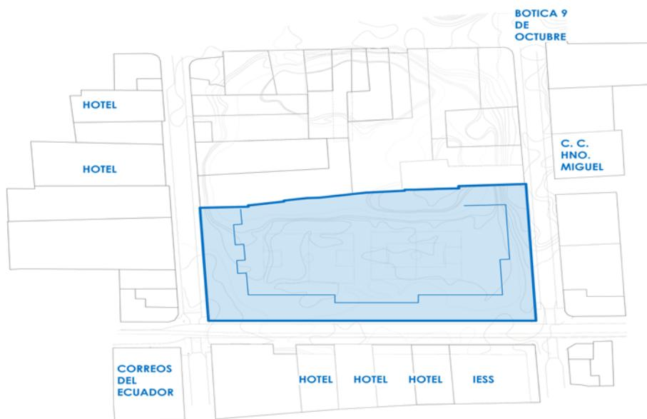
Ilustración 6: Levantamiento planimétrico de la escuela; se destaca el perfil exterior e interior de la edificación y las calles aledañas como punto de partida para el relevamiento detallado de los espacios interiores y de sus componentes.
