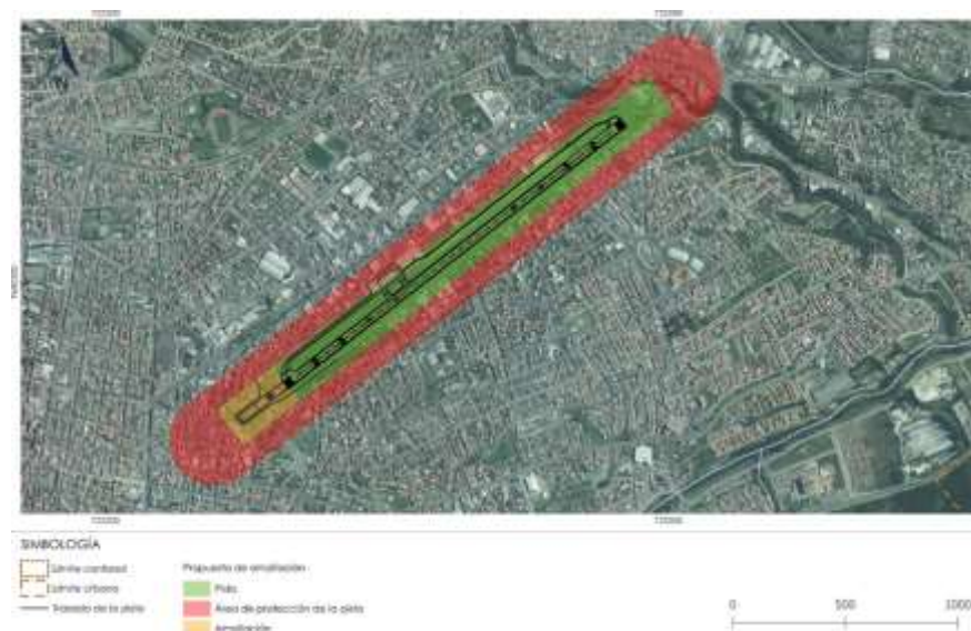
Figura 64. Franja de protección estricta del aeropuerto
