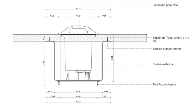
DETALLE DE SUJECCIÓN DE LUMINARIA EN PISOS DE CAMINERÍA DE MADERA
