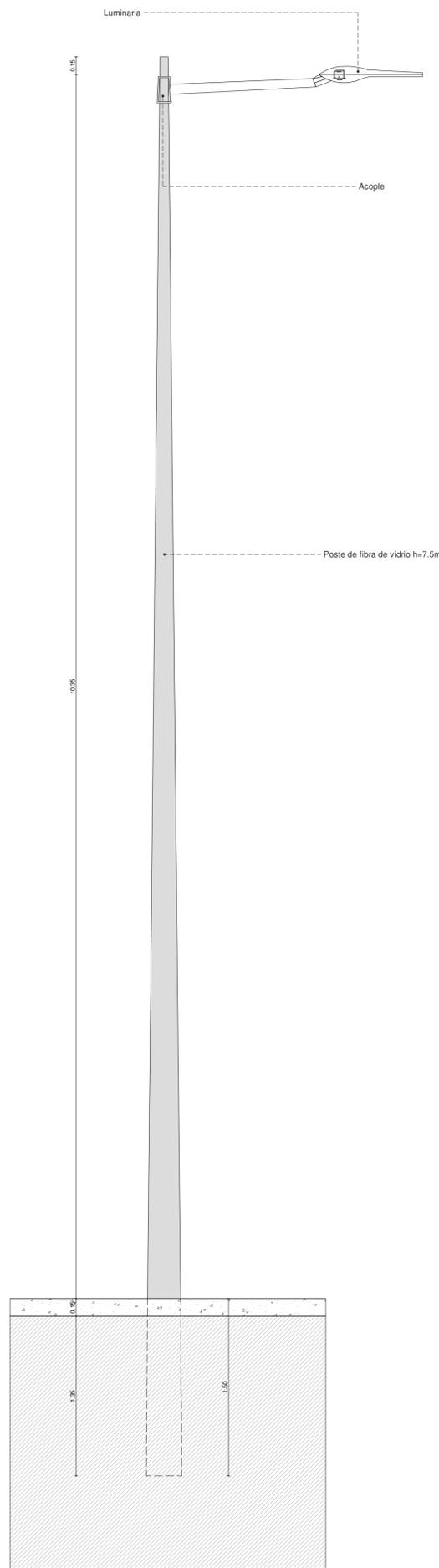
ELEVACIÓN LUMINARIA SIMPLE TIPO POSTE
