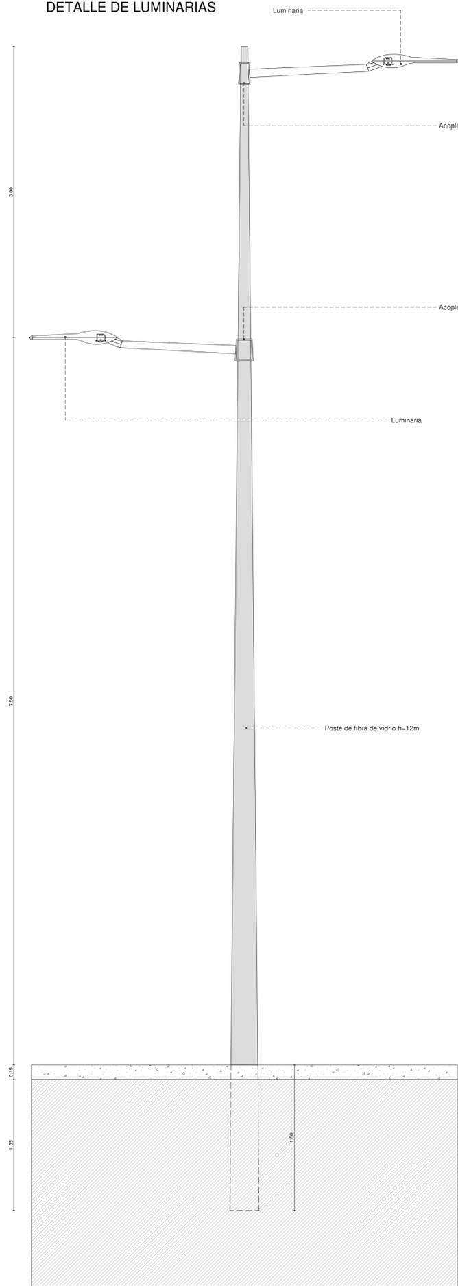
ELEVACIÓN LUMINARIA DOBLE TIPO POSTE
