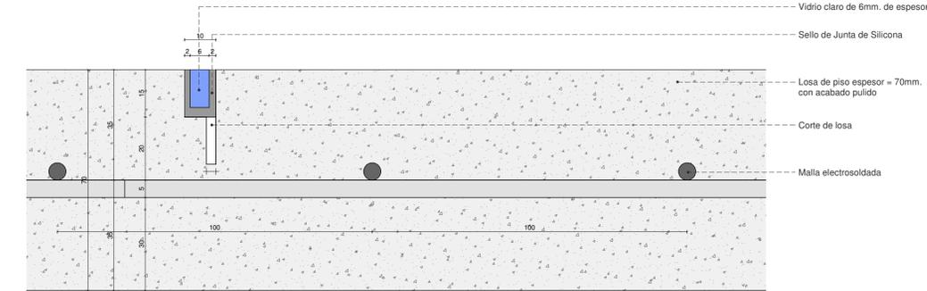
JUNTA DE DILATACIÓN PARA PISOS DE HORMIGÓN PULIDO
