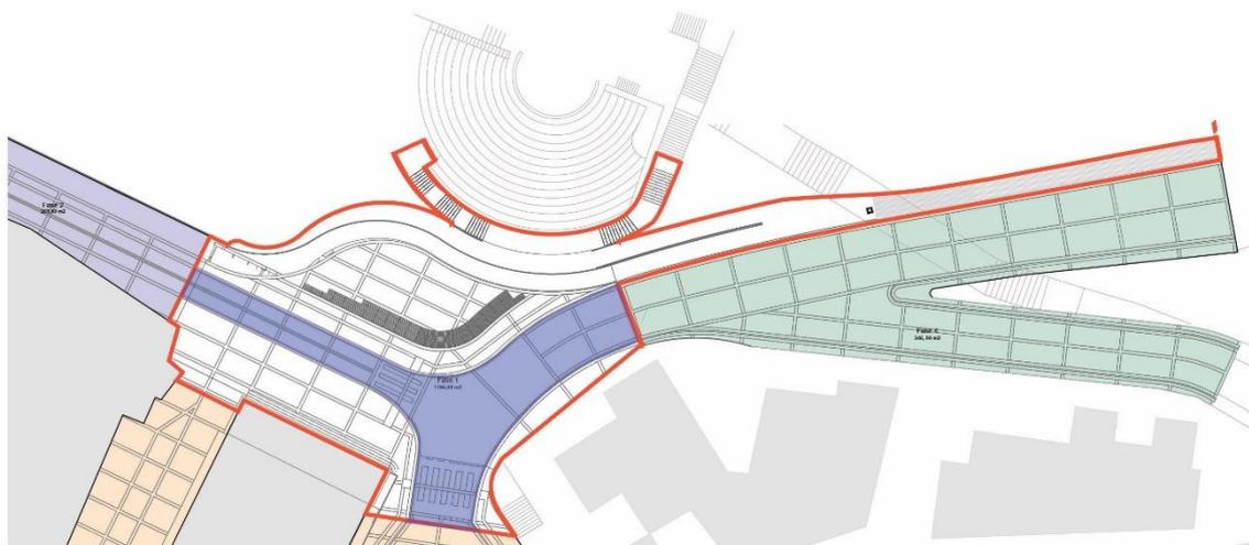
La losa de hormigón debe contar con juntas cada 3.50 m y será reforzada con una malla electro soldada tipo U-196, caracterizada por 1 varilla de 5 mm cada 10 cm. Estas dos medidas ayudaran a evitar efectos de contracción y temperatura en la losa.
